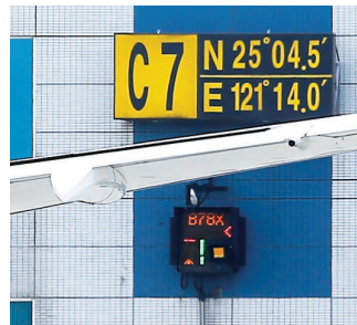
▲長榮航空波音B787-10型客機由機長操作滑行進入桃園機場C7停機位，目視停靠導引系統的顯示幕上的操作資訊，最上方「B78X」字樣為機型。
