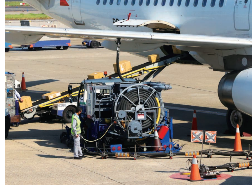
▲加油廠商的油栓車替航機加油，右下方可以看到油管一端連上地下加油坑的管口，另外一端接到飛機主翼中段的受油口。
