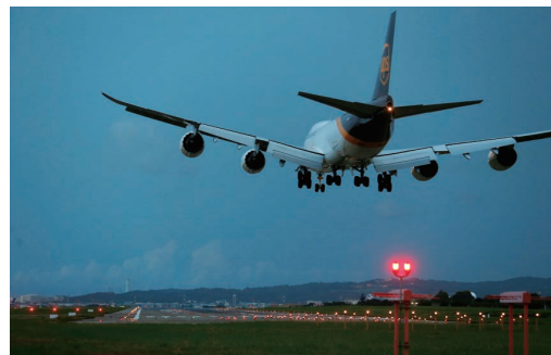
▲美商優比速航空貨運（UPS）波音B747-8F全貨機準備降落05R跑道，跑道降落區的燈光系統清晰可見。左下角可以看到4盞精確進場滑降指示燈（PAPI），因為攝影角度視角位置偏低，全部呈現紅色。
