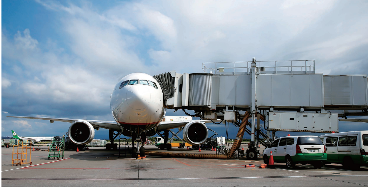
▲停放在桃園機場停機坪的長榮航空客機，連接橋氣（右側空橋下方橘黃色管線）、橋電（鼻輪旁彎折的黑色纜線）展開地勤作業。空橋下方支柱右側的長方形箱狀物內裝橋氣設備，支柱左方較小型的盒狀物內為橋電設備。
