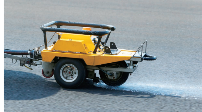
▲（左）摩擦車特寫。依美國聯邦航空總署（FAA）及國際民航組織（ICAO）規範，沿著跑道中心線兩邊3到5公尺檢測時，檢測儀器設定自動灑水，產生1mm厚度水膜，模擬跑道道面上留存的雨水。（右）桃園機場共有8輛機場專用泡沫消防車，每輛造價3,200萬元，消防能量符合國際民航組織最高等級規範。
